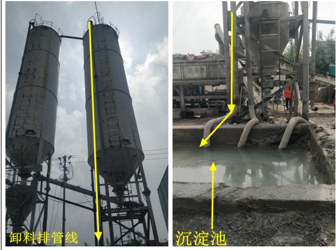
图 2-2 水稳生产线除尘工艺
