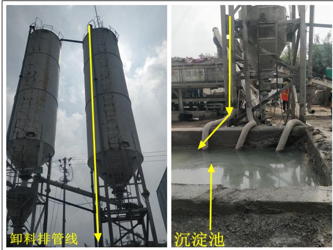
图 3-4 水稳生产线除尘工艺图
